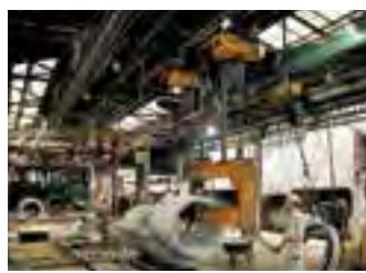
2台以上の電気チェーンブロックを1個の押しボタンスイッチで同時に操作できるタイプです。重量の割に容積が大きい品物、長尺物(コンクリート・鋼材等)などの運搬に適しています。
