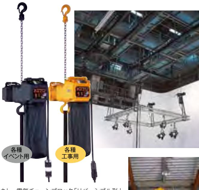
キトーディスクブレーキ付電気チェーンブロック「リバーシブル形」は、フックを天井の梁などに掛けるだけで荷のつり上げができます。仮設の建築現場や舞台、スタジオなどの作業現場に持ち運んで簡単に設置が可能。また、本体を天井の梁側につり替え、通常通り同じように使用できます。1速形・2速形で250kg～1tまでご用意しております。
