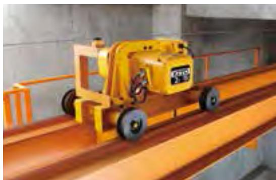
キトーダブルレール形トロリ式電気チェーンブロックは、レールからつり下がる標準製品に対して、レールより上に巻上機があるため、揚程が長く確保できます。定評あるキトーエクセル(ER2形)を据置形にした構造のため、極めてシンプルです。
